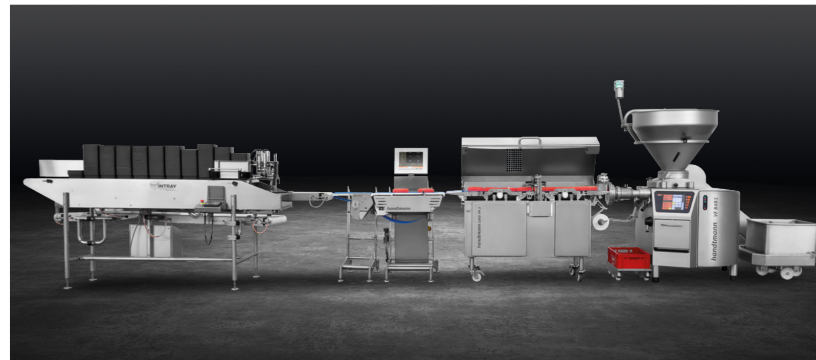
↓ Рисунок 7: Линия Handtmann для производства веганского фарша
